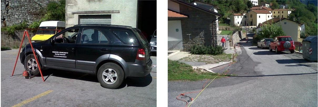
Profilo sismico per la verifica sismica della scuola di Treppio (Sambuca P.se)
